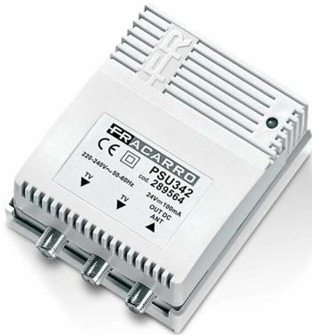
Alimentatore di tipo switching stabilizzato 24V ad alta efficienza e basso consumo con 1 ingresso, 2 uscite e corrente erogata 100mA. Spina di tipo C di connessione alla rete elettrica.
