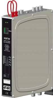
Modulatori A/V vestigiali, adatti a distribuire canali adiacenti, con uscita full-band da 47 a 862 MHz, banda S inclusa. Disponibile nelle 3 versioni con modulatore PAL B/G mono, PAL B/G stereo e mono multi-standard.
