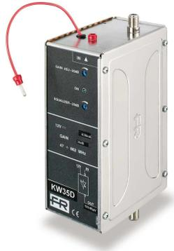
Amplificatori finali larga banda con tecnologia push-pull in grado di amplificare tutta la banda 47-862 MHz. Dotati di un ingresso e una uscita, si utilizzano per amplificare il segnale proveniente da una batteria di filtri KF o di altri moduli (ricevitori, modulatori, ecc).
