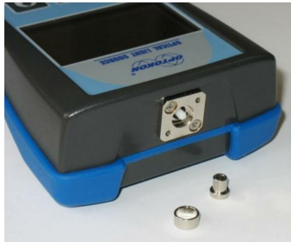
Se necessario, pulire accuratamente la superficie terminale della ghiera utilizzando alcool e salviette da laboratorio senza lasciare pelucchi.
