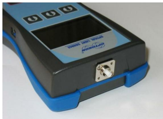
3. Utilizzando la ghiera del connettore ottico, rimuovere con attenzione il manicotto dell'adattatore
