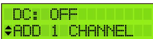
Se dovesse essere necessario utilizzare dei preamplificatori da palo, impostare in ON la telealimentazione nella sezione **"DC"**. La massima corrente disponibile è 100mA per tutti e 4 gli ingressi VHF/UHF.
