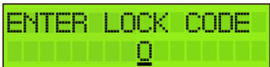
Ogni volta che la centrale uscirà dalla programmazione o verrà riavviata dopo una mancanza di alimentazione, per accedere al menu di programmazione sarà necessario inserire il codice di sblocco.
