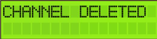
Per eliminare un canale singolo od una coppia , posizionarsi sopra al canale od alla coppia e premere il tasto di conferma per 3 secondi, apparirà il messaggio **"CHANNEL DELETED"** come da figura.
