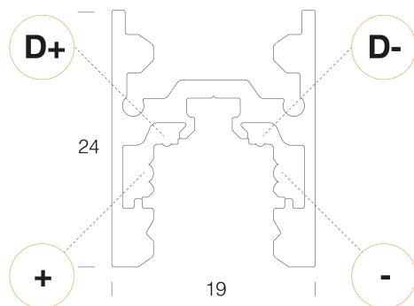
Corpo In alluminio estruso con conduttori in rame.
