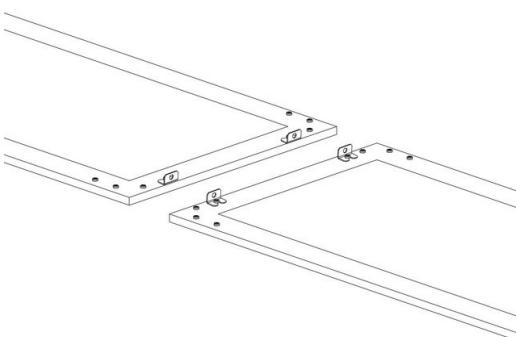
in acciaio. utilizzare per installazione dei pannelli in fila continua.
