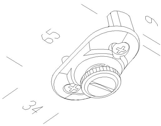
Corpo utilizzare con i proiettori di peso superiore ai 5 kg. Si consiglia l'uso per il montaggio dei proiettori quando il binario è a parete.
