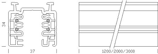
Corpo Binario trifase. Di sezione rettangolare in alluminio estruso, contiene un profilo sagomato in PVC isolante dotato di 4 conduttori in rame. Portata max 16A per ogni conduttore. Si possono montare la maggior parte degli adattatori in commercio
