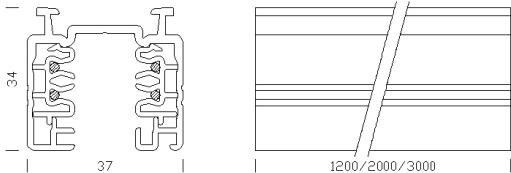
Corpo Binario trifase. Di sezione rettangolare in alluminio estruso, contiene un profilo sagomato in PVC isolante dotato di 4 conduttori in rame. Portata max 16A per ogni conduttore. Si possono montare la maggior parte degli adattatori in commercio
