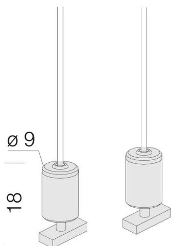
Sospensione completa di cavetto in acciaio (L=1,50m) con regolazione millimetrica. Carico max: 20 Kg.
