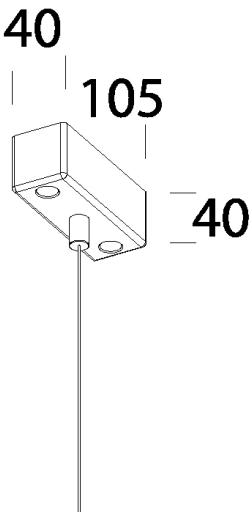
Corpo completa di cavetto in acciaio (l = 100 cm) con dispositivo per regolazione millimetrica. Carico max: 20 Kg.
