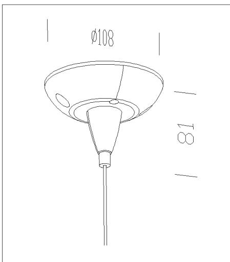
Corpo cavo in acciaio (l=1,5m) con dispositivo per regolazione millimetrica.
