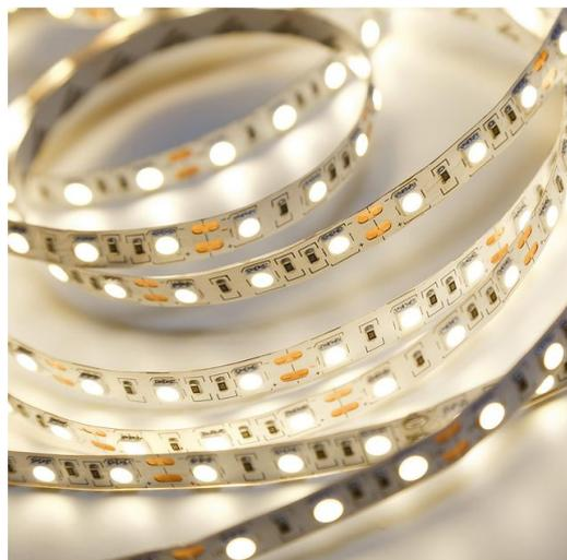
Strisce a LED applicabili su superfici lisce, pulite ed asciutte con adesivo 3M. Evitare l'installazione su superfici spigolose e il danneggiamento delle componenti. Le strisce possono essere tagliate seguendo le linee di taglio. \*Attenzione: nel caso di taglio non utilizzare forbici ma un cutter. Per garantire il corretto funzionamento e il grado IP, ripristinare il cablaggio delle strip come in origine (nel caso utilizzare connettori) Nota valida per tutte le strisce LED.
