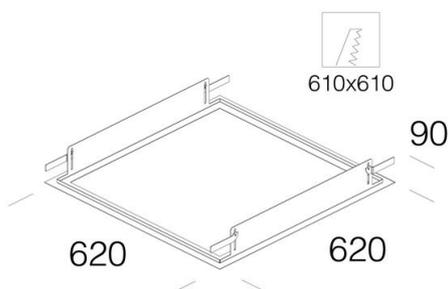
Ideale per l'installazione dell'apparecchio in controsoffitti di cartongesso.
