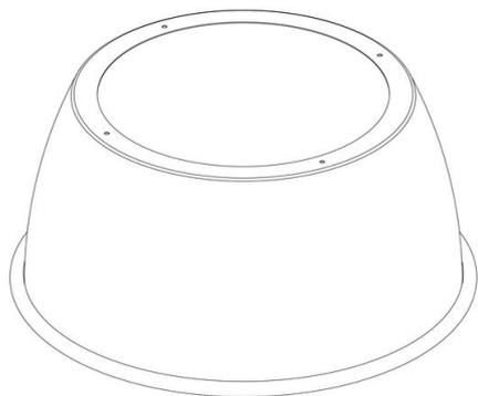
in alluminio stampato prismaticizzato, ossidato anodicamente con sp. 3  $\mu$  e brillantato per un elevato rendimento luminoso.
