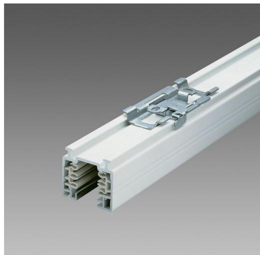
in acciaio. Dispositivo di fissaggio a plafone o a parete con possibilità di scorrimento lungo l'asse del binario. Carico max 20 Kg ogni 35 cm.
