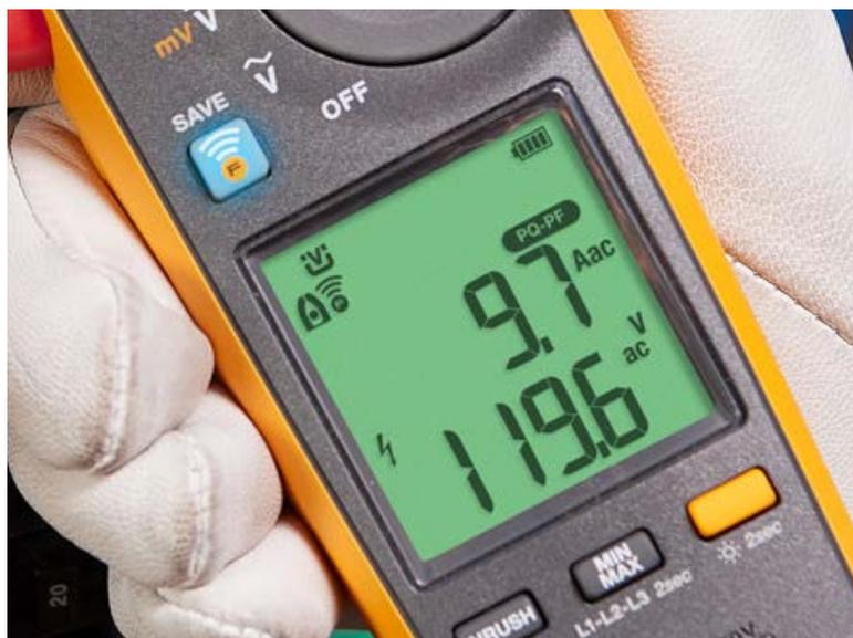
Il modello 378 FC include un test sulla qualità dell'alimentazione per un rapido rilevamento di eventuali problemi di alimentazione in ingresso o dell'apparecchiatura.
