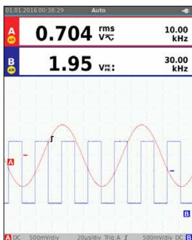
Il trigger Fluke Connect-and-View™ con funzione AutoReading che utilizza la tecnologia Fluke IntellaSet™ consente di accedere rapidamente ai dati necessari.
