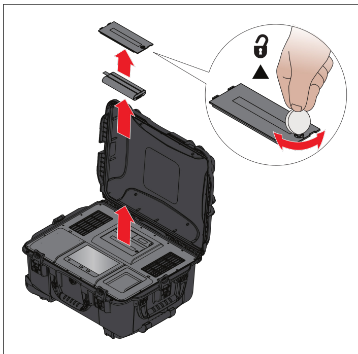
Figura 1. Rimozione della batteria
