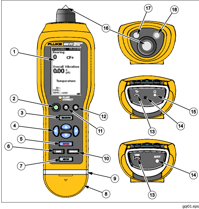
Figura 1. Comandi e connettori sullo strumento
