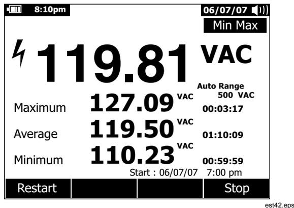
Figura 6. Schermata della registrazione MIN MAX
