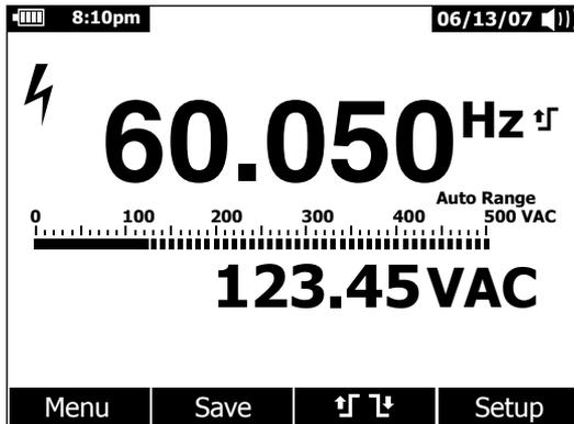
**Figura 24. Schermata delle misure di frequenza**
