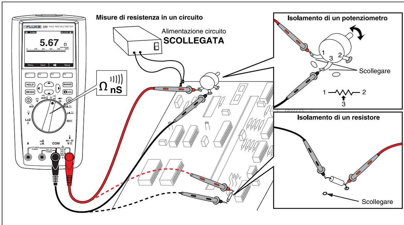
Figura 15. Misure di resistenza
