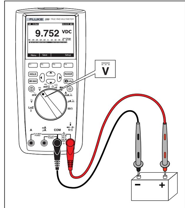
Figura 12. Misure di tensione DC
