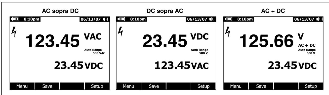
Figura 13. Schermata delle modalità AC e DC
