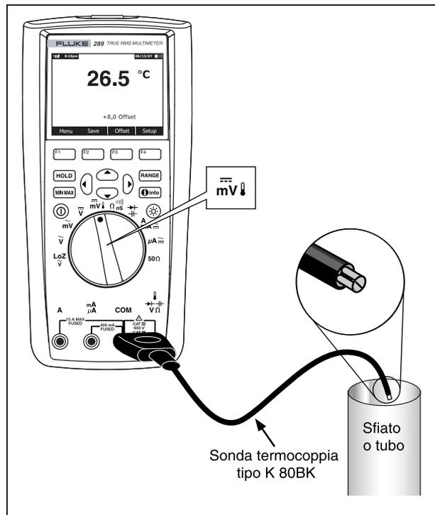
Figura 14. Misure di temperature
