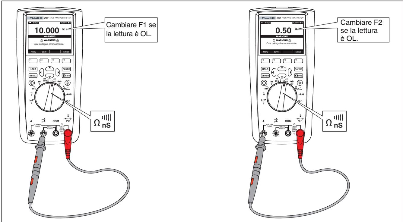
Figura 28. Verifica dei fusibili per le misure di corrente
