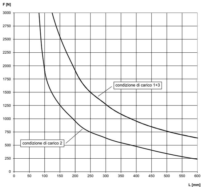
Nelle curve di carico la tensione dell'acciaio ammissibile  $\sigma_{adm} = 188 \text{ N/mm}^2$  (resistenza allo snervamento incrementata grazie alle piegature). L'inflessione massima L/150 non viene superata. Connessioni e fissaggi devono essere dimensionati in maniera adeguata.
