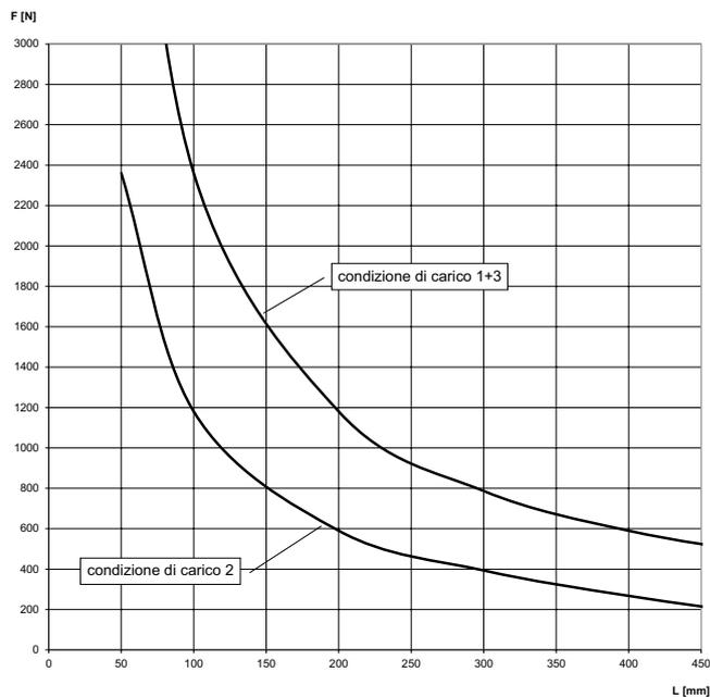
Nelle curve di carico la tensione dell'acciaio ammissibile  $\sigma_{\text{adm}} = 188 \text{ N/mm}^2$  (resistenza allo snervamento incrementata grazie alle piegature). L'inflessione massima  $L/150$  non viene superata. Connessioni e fissaggi devono essere dimensionati in maniera adeguata.
