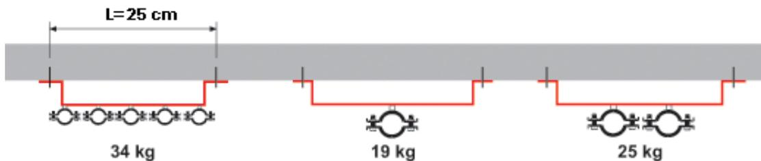
Carichi raccomandati<sup>1)</sup> per staffatura a soffitto<sup>1)</sup> mediante Sistema QUICK-FIX con larghezza L=30 cm.
