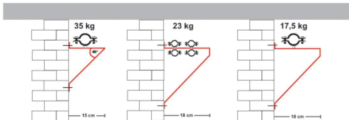
1) Nel calcolo del carico ammissibile sono stati considerati i coefficienti parziali di sicurezza per la resistenza dei materiali e il coefficiente parziale di sicurezza per le azioni  $\gamma_L = 1,4$ .
