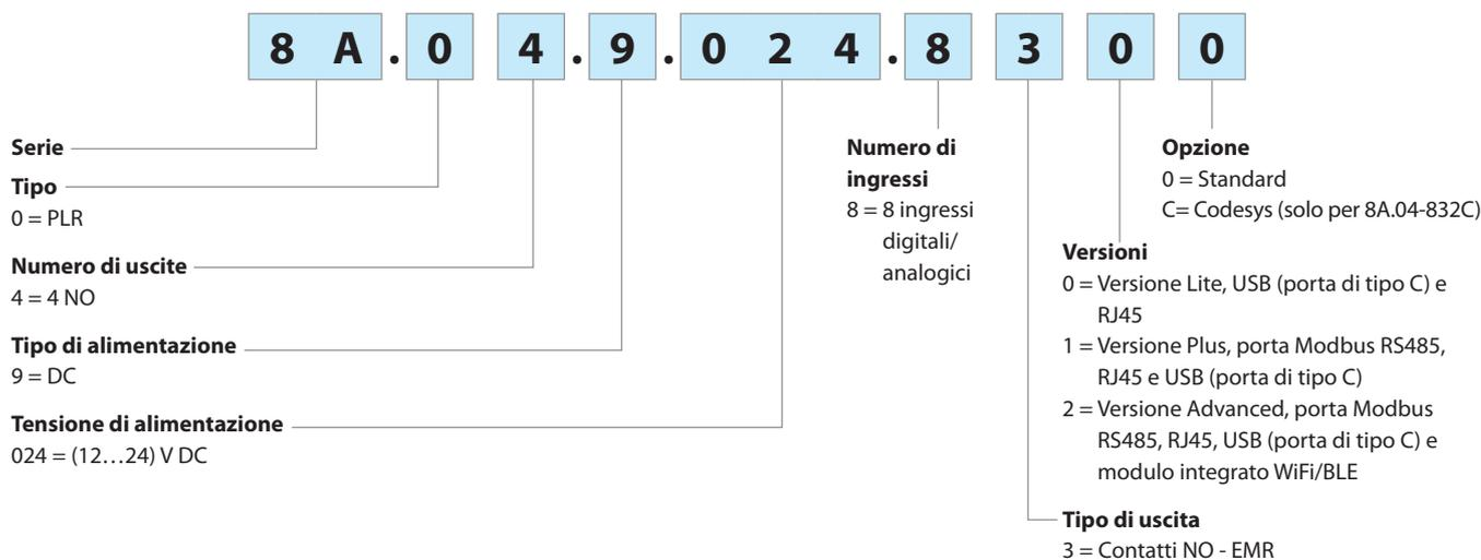
Esempio: serie 8A, espansione digitale EMR, 8 uscite NO elettromeccaniche 6 A, 16 ingressi digitali/analogici (0...10 V), alimentazione 12...24 V DC
