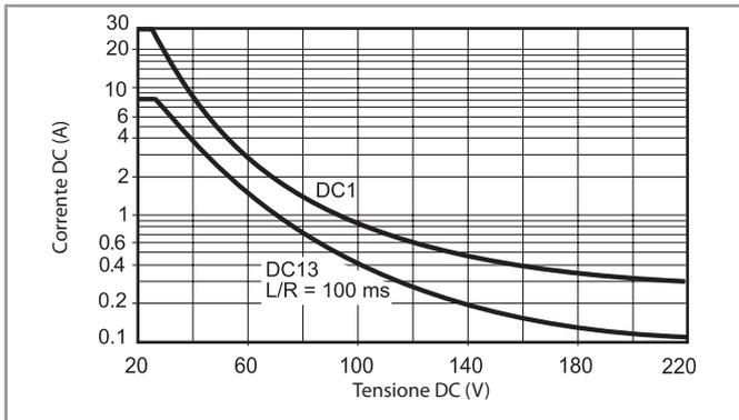
**H 66 - Massimo potere di rottura su carichi in DC1, versione x60x**
