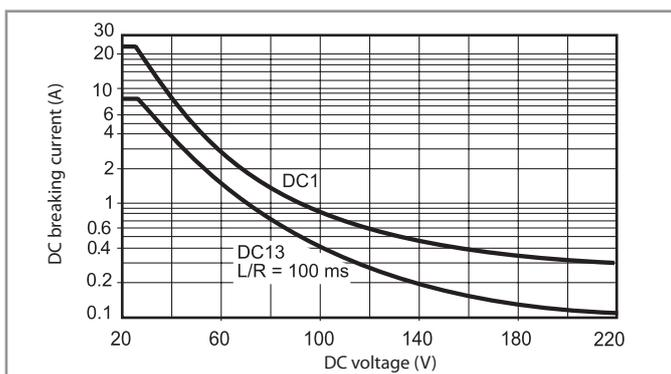
**H 66-2 Massimo potere di rottura su carichi in DC1, versione x60x (distanza tra contatti aperti ≥ 1.5 mm)**
