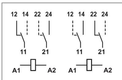
Esempio di utilizzo dei contatti NO e NC come contatti guidati in conformità alla EN 61810-3 (Tipo B).
