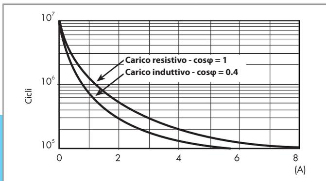
H 50 - Massimo potere di rottura su carichi in DC1 (tipo 50.12)
