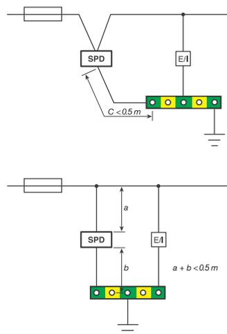
La sezione dei conduttori di collegamento (in rame) non deve essere inferiore a:
