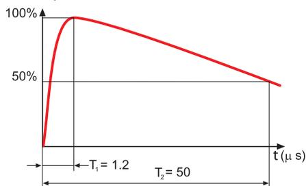
Figura 7: forma d'onda di tensione 1.2/50 μs
