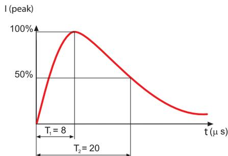
Figura 6: forma d'onda di corrente 8/20 μs
