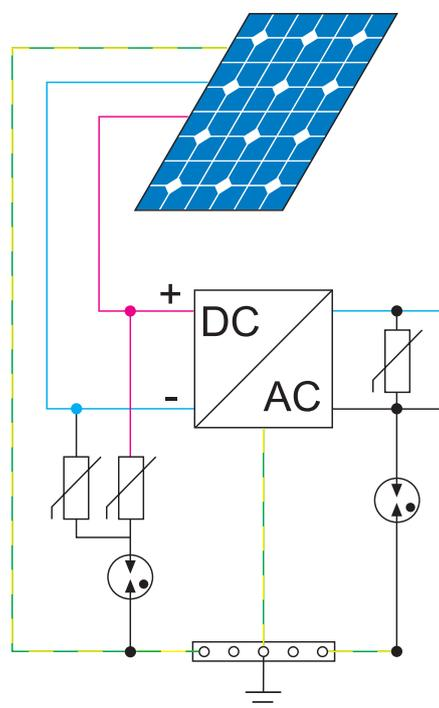
Figura 10: schema esemplificativo di un impianto fotovoltaico installato su un edificio senza LPS protetto sul lato DC da scaricatori con  $U_{OCSTC} = 420 V$ , sul lato AC da un 7P.22 specifico per impianti TT.
