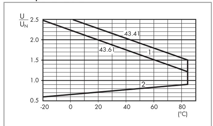
1 - Max tensione bobina ammissibile.
