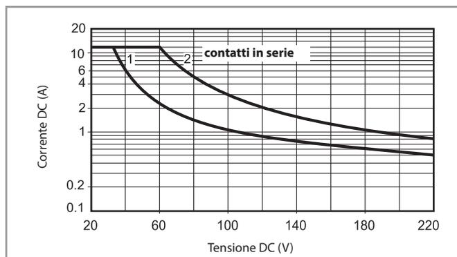
• La durata elettrica per carichi resistivi in DC1 aventi valori di tensione e corrente sotto la curva è  $\geq 100 \cdot 10^3$  cicli.
