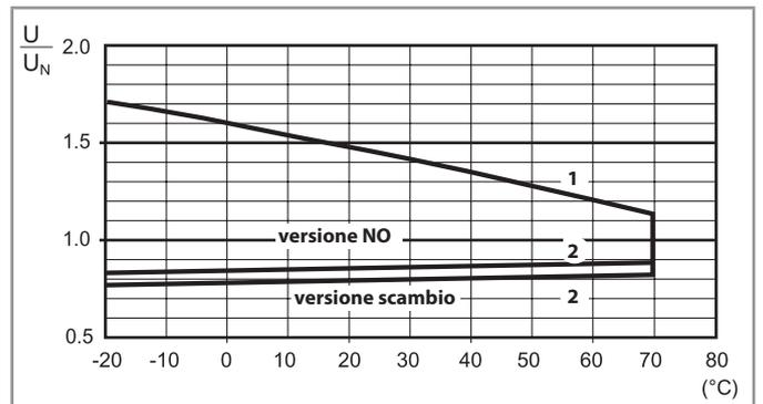
R 56 - Campo di funzionamento bobina AC in funzione della temperatura ambiente, 4 scambi
