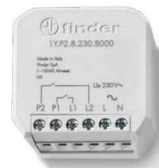
L'interfaccia YESLY 1Y.P2 con 2 input è stata sviluppata per integrare facilmente qualsiasi contatto pulito o in fase con il sistema YESLY. Con l'interfaccia tipo 1Y.P2, è possibile controllare i singoli dispositivi oppure un qualsiasi scenario luci o tapparelle utilizzando la serie civile scelta.
