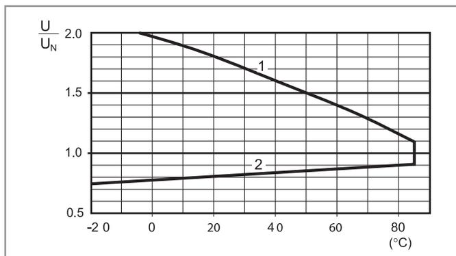
1 - Max tensione bobina ammissibile.
