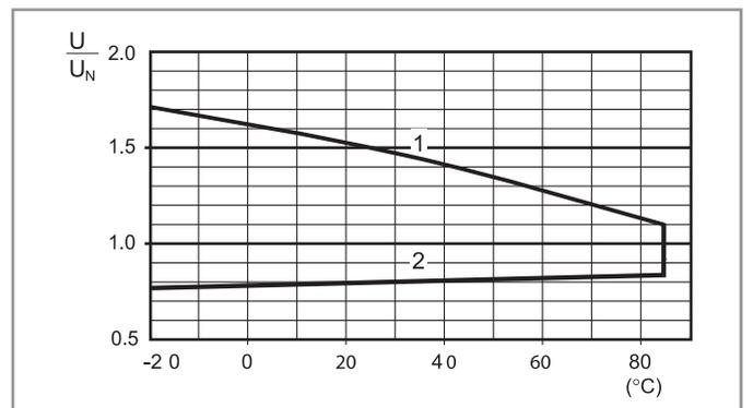
1 - Max tensione bobina ammissibile.
