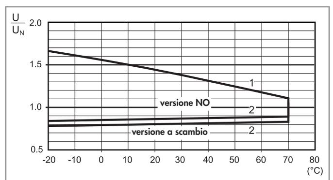
1 - Max tensione bobina ammissibile.
