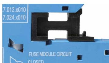
1. Con il modulo porta fusibile inserito, il fusibile è collegato elettricamente in serie con il terminale comune dell'interfaccia (11 per le versioni EMR, 13+ per le versioni SSR, 15 per il temporizzatore EMR, 15+ per il temporizzatore SSR). Questo stato è indicato dal piolo indicatore.
