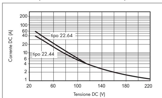
• La durata elettrica per carichi resistivi in DC1 aventi valori di tensione e corrente sotto la curva è  $\geq 100 \times 10^3$  cicli.
