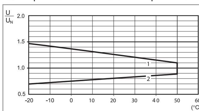
1 - Max tensione bobina ammissibile.
