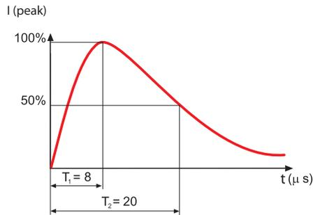
Figura 6: forma d'onda di corrente 8/20 μs
