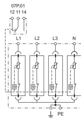
**SPD Scaricatori di sovratensione Tipo 2 per sistemi AC monofase o trifase e per sistemi DC**
