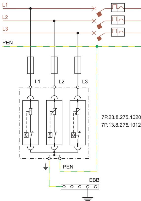
Esempi di schemi d'installazione monofase per SPD di Tipo 3
