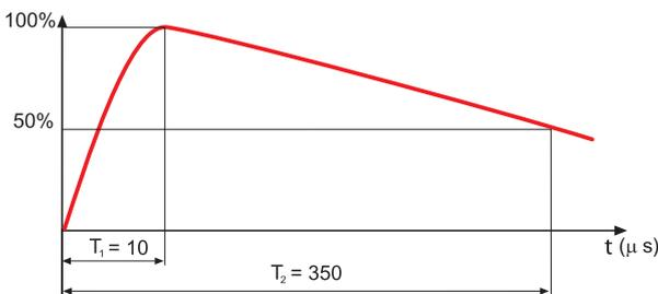
Figura 5: forma d'onda di corrente 10/350 μs
