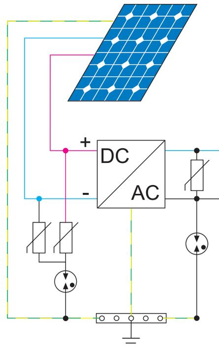
Figura 10: schema esemplificativo di un impianto fotovoltaico installato su un edificio senza LPS protetto sul lato DC da scaricatori con  $U_{OCSTC} = 420 V$ , sul lato AC da un 7P.22 specifico per impianti TT.
