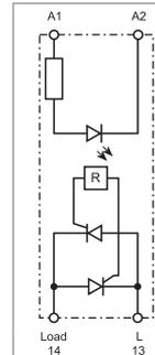
**Relé modulare allo stato solido 7 - 15 A, uscita 1 NO, bobina DC**
