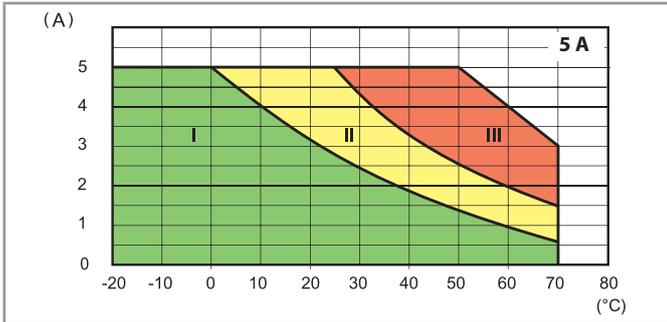
**L77-2 Corrente RMS di uscita in funzione della temperatura ambiente**
