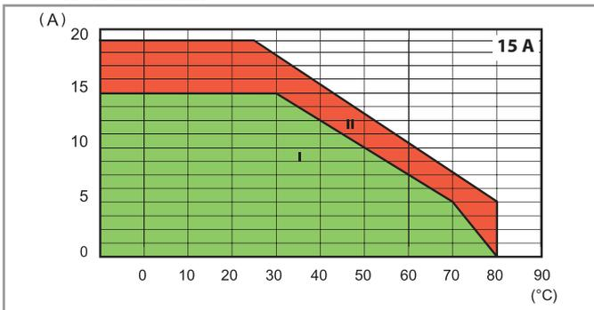
**L77-4 Corrente RMS di uscita in funzione della temperatura ambiente**
