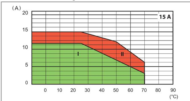
**L77-13 Corrente DC di uscita in funzione della temperatura ambiente**
