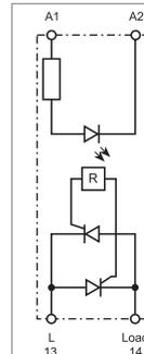
**Relé modulare allo stato solido, uscita 1NO 30 A**
