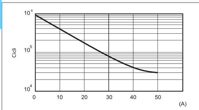
**H 67 - Massimo potere di rottura su carichi in DC (67.xx-x300)**
