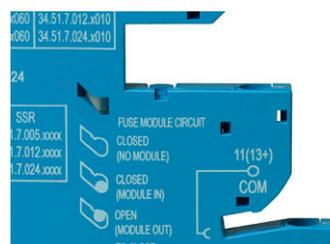
**1.** Con il modulo porta fusibile inserito, il fusibile è collegato elettricamente in serie con il terminale comune dell'interfaccia (11 per le versioni EMR, 13+ per le versioni SSR, 15 per il temporizzatore EMR, 15+ per il temporizzatore SSR). Questo stato è indicato dal piolo indicatore.
