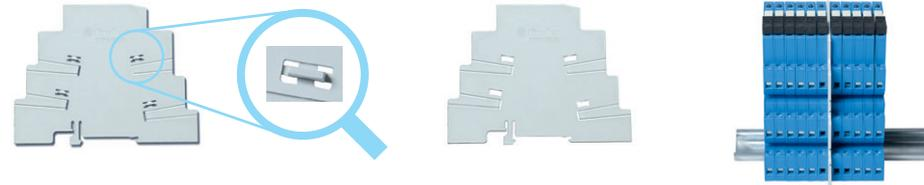
2. Lasciando le nervature si può ottenere una separazione di 6.2 mm. Tagliando le relative sezioni con delle semplici forbici, è possibile una interconnessione attraverso il separatore di 2 gruppi di interfaccia, utilizzando il pettine di collegamento.
