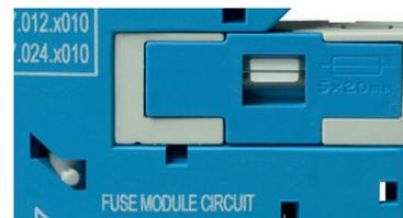
**2.** Se il modulo porta fusibile viene estratto (per esempio, perchè il fusibile si è interrotto) l'uscita del circuito sarà bloccata in posizione aperta, per motivi di sicurezza. Questo stato è indicato dal piolo indicatore.
