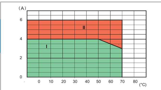
**L 34 - Corrente AC di uscita in funzione della temperatura ambiente**
