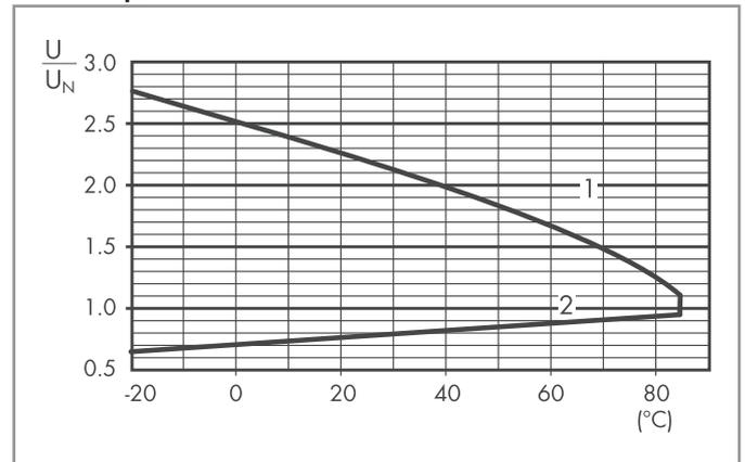
1 - Max tensione bobina ammissibile.
