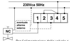
Per l'alimentazione della valvola a 230V 50Hz, collegare i morsetti 4-5
