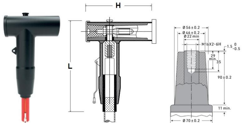
Terminali sconnettabili cono esterno a T asimmetrici per cavi unipolari ad isolamento estruso per tensioni fino a 36kV, corrente massima 630 A – interfaccia C – con capocorda a frattura idoneo per cavi con conduttori in rame ed in alluminio con schermo a fili o a nastri in rame.
