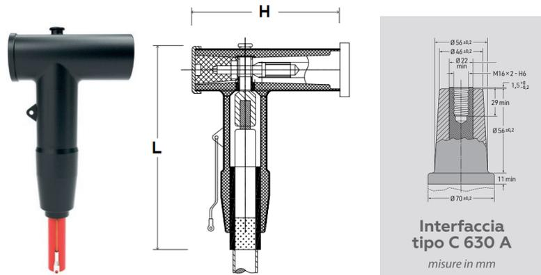
Terminali sconnettabili a cono esterno asimmetrici per cavi unipolari ad isolamento estruso per tensioni fino a 36kV, corrente massima 630 A – interfaccia C – con capocorda a frattura idoneo per cavi con conduttori in rame ed in alluminio con schermo a fili di rame oppure tubo rigido di alluminio.
