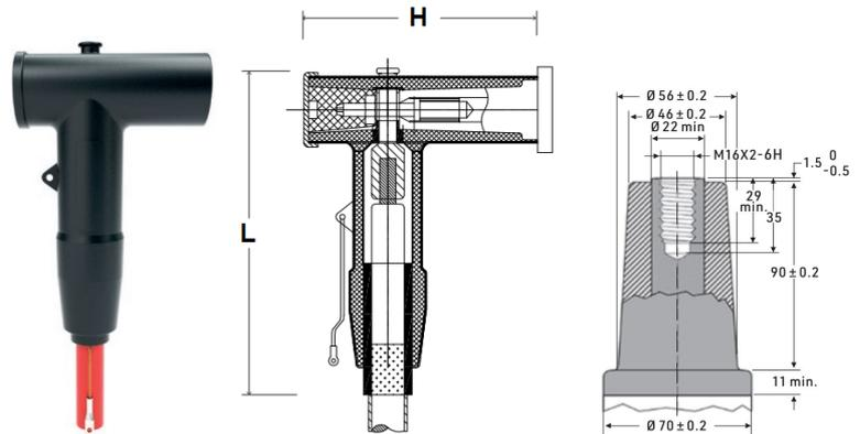
Terminali sconnettabili cono esterno a T asimmetrici per cavi unipolari ad isolamento estruso per tensioni fino a 24kV, corrente massima 630 A – interfaccia C – con capocorda a frattura idoneo per cavi con conduttori in rame ed in alluminio con schermo a fili o a nastri in rame o a tubo in alluminio.
