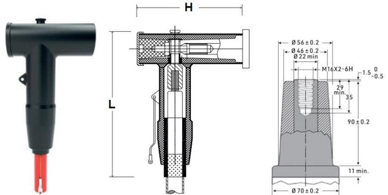
Terminale Sconnettibile a cono esterno a "T" asimmetrico per cavi unipolari ad isolamento estruso fino a 24kV, con portata massima di 630 A – interfaccia C – con capocorda a frattura idoneo per cavi con conduttori in rame ed in alluminio con schermo a tubo in alluminio o a fili in rame.
