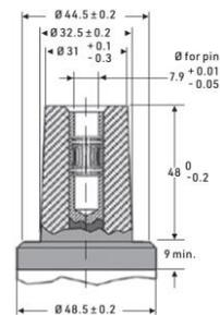
Terminali sconnettabili cono esterno a squadra per cavi unipolari ad isolamento estruso per tensioni fino a 24kV, corrente massima 250 A – interfaccia A – con capocorda a compressione e spina di contatto idonei per cavi con conduttori in rame ed in alluminio con schermo a fili o a nastri in rame.
