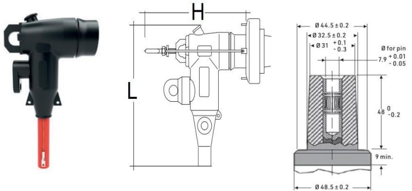
Terminali sconnettibili con esterno a squadra per cavi unipolari ad isolamento estruso per tensioni fino a 24kV, corrente massima 250 A – interfaccia A – con capocorda a serraggio meccanico e spina di contatto idonei per cavi con conduttori in rame ed in alluminio con schermo a fili o a tubo rigido di alluminio.
