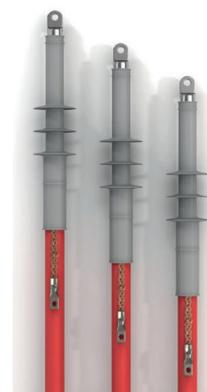
Singolo terminale autorestringente per applicazioni da interno per cavi unipolari ad isolamento estruso fino a 24 kV con schermo a fili in rame, a nastri in rame o a tubo in alluminio.
