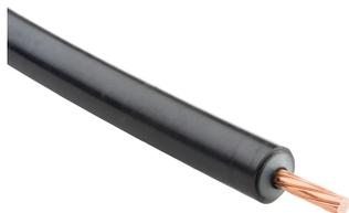
Il conduttore isolato di discesa ISONV è una calata di protezione specializzata contro i fulmini, che, durante il funzionamento, può essere soggetta a correnti a impulsi di oltre 200 kA. ISONV è progettato e testato per controllare la distanza di separazione e l'arco elettrico. Uno strato esterno semi-conduttivo viene utilizzato per ridurre al minimo i gradienti di tensione nelle condizioni ambientali in cui vengono scaricati i fulmini.
